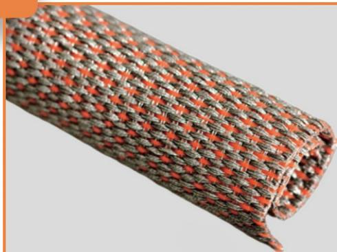
**TEMI2352** 是由橙色聚酯单丝和镀锡铜箔丝混编而成，具有电磁屏蔽功能。加入橙色聚酯单丝方便识别高压电线同时增加耐磨性和柔韧度。比常规镀锡铜材质减重 30%。
